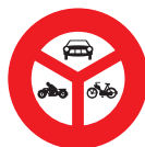
2.14 Divieto di circolazione per gli autoveicoli e i motoveicoli ed i ciclomotori (Unicamente all'interno delle località o sulle strade secondarie poco importanti)
