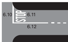
6.10 Ligne d'arrêt 6.11 Stop 6.12 Ligne longitudinale continue
