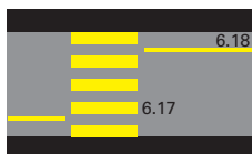
6.17 Passage pour piétons 6.18 Ligne interdisant l'arrêt
