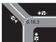
6.16.3 Ligne de guidage sur route principale changeant de direction
