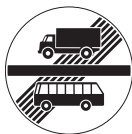
2.56.1 Fin de l'interdiction partielle de circuler (exemple)
