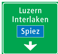
4.69 Panneau de présélection au dessus d'une voie de circulation sur autoroute et semi-autoroute
