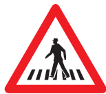
1.22 Passage pour piétons (Annonce les passages que le conducteur ne peut apercevoir à temps et les passages se trouvant sur de routes à trafic dense)
